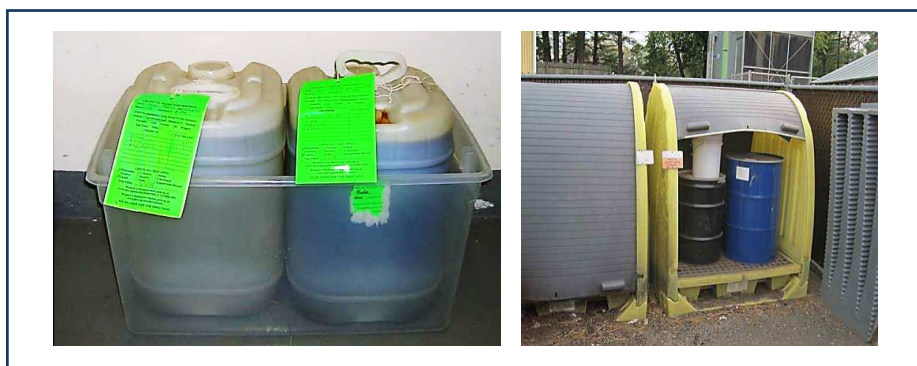
شکل ۱-۵: روش صحیح نگهداری موقت ظروف حاوی مواد شیمیایی
